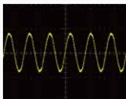
白熱電球の電流波形 (クレストファクタ=1.4)
