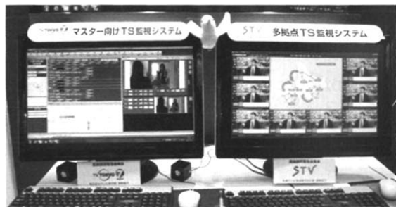
「AlertMagic」TS監視画面例 各局の仕様に基づきカスタマイズされている
